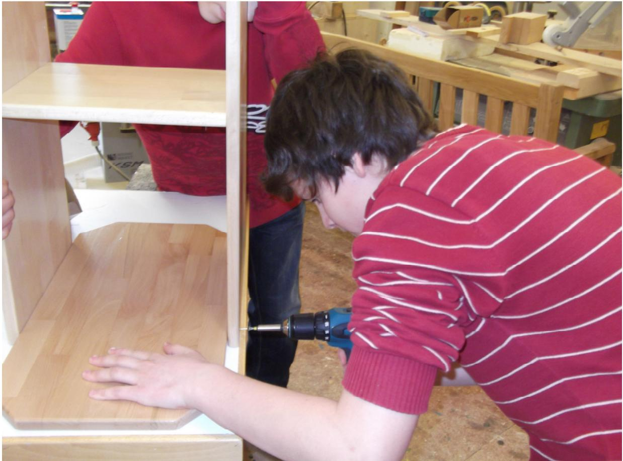
Diese Holzstühle wurden aus verschiedenen Holzplatten angefertigt, die unser Lehrer für uns zugeschnitten hat. Anschließend haben wir auf den Platten unsere Bohrpunkte eingezeichnet und danach die Löcher gebohrt. Dann haben wir die Stühle sauber geschliffen und anschließend einmal durchlackiert. Die zweite Lackierung hat unser Techniklehrer übernommen.
